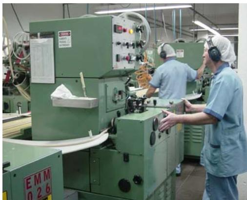
**Figura 18 - Operador de máquina controlando a máquina de embalagem das balas**
