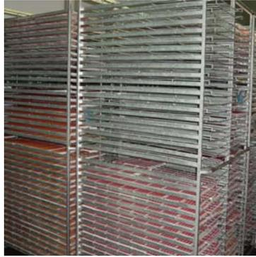
**Figura 04 - Estantes onde as fôrmas com as balas *diet* são estocadas na estufa, após chegarem da máquina pingadeira**
