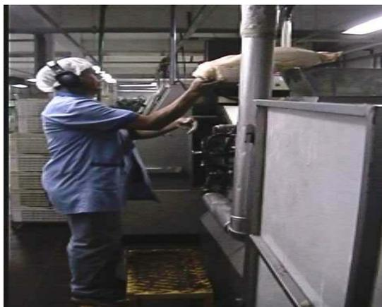
**Figura 16 - Colocação da massa na extrusora**
