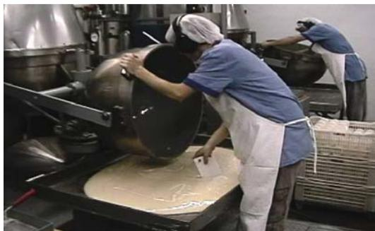
**Figura 11 - Retirada da massa do cozinhador da bala mastigável, após o cozimento da mesma por 2 a 3 minutos**
