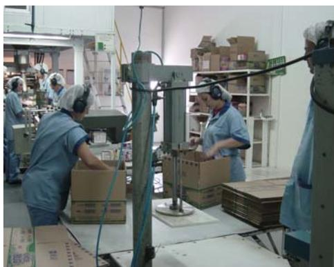
**Figura 21 - As balas são embaladas, depois empacotadas em sacos plásticos, os quais são encaixotados e fechados com fita adesiva**
