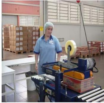
**Figura 10 - Os *displays* vêm por uma esteira, são colocados em caixas de papelão e fechados com fita adesiva**
