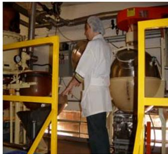
**Figura 01 - Cozinhador da bala *diet* (os cozinhadores recebem a matéria-prima por tubulação, são acionados e permanecem ligados por 2 a 3 minutos até ocorrer o cozimento da calda)**
