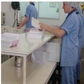
**Figura 09 - Montagem dos *displays* e colocação de latinhas em bandejas plásticas (*display*)**
