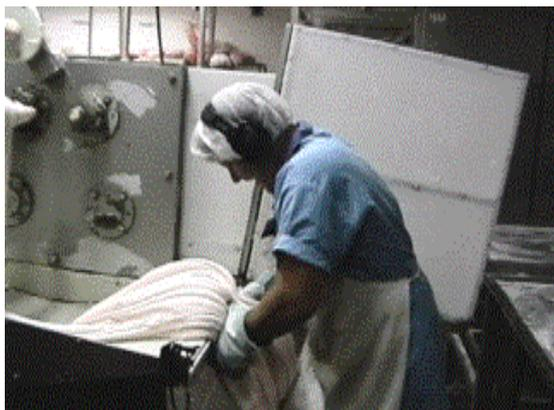
**Figura 15 - Recorte da massa, em pedaços, após ser homogeneizada nos puxadores**
