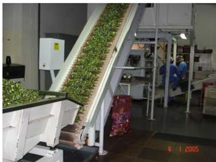
**Figura 20 - Caçamba com balas e encaminhamento das mesmas pela esteira até a máquina de empacotamento**
