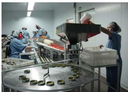
**Figura 06 - Colocação de bala *diet* na extrusora, abaixo da qual há uma mesa giratória, onde estão as latinhas**
