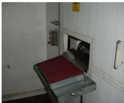
**Figura 05 - Posto onde é onde ocorre a saída das fôrmas da máquina desenformadeira da bala *diet***
