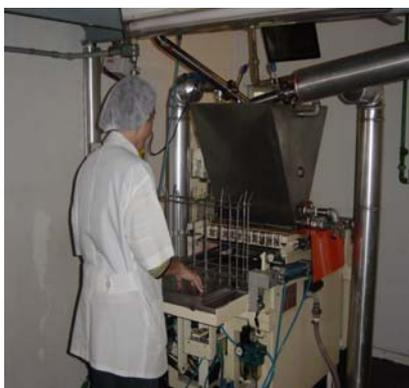
**Figura 03 - Máquina pingadeira, para onde a massa pronta desce por tubulação dos misturadores e de onde cai em forma de gota nas fôrmas**
